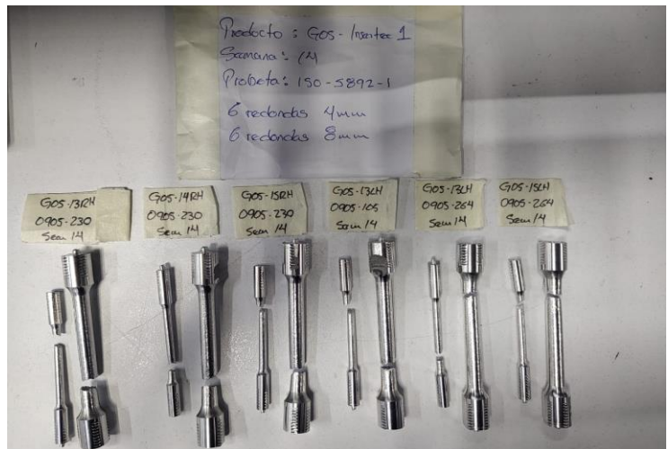
Imagen 4. Ruptura de items. Image 4. Broken items.
