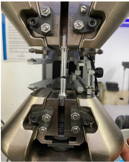
Imagen 3. Ítem a la ruptura. Image 3. Item at break.
