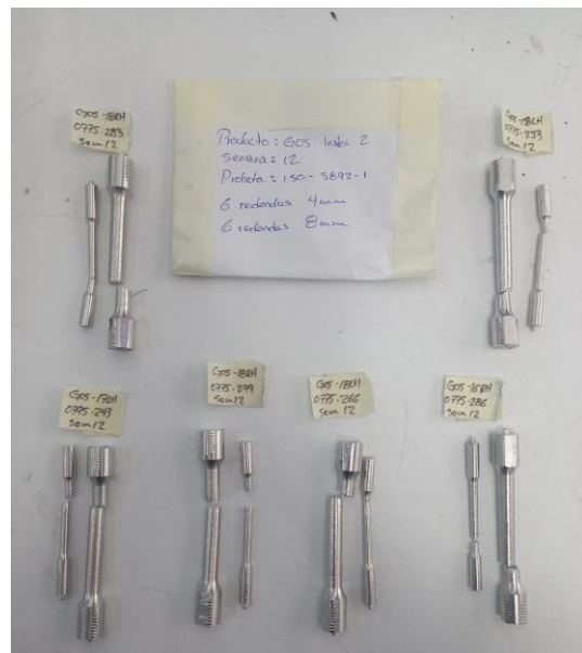
Imagen 4. Ruptura de items. Image 4. Broken items.
