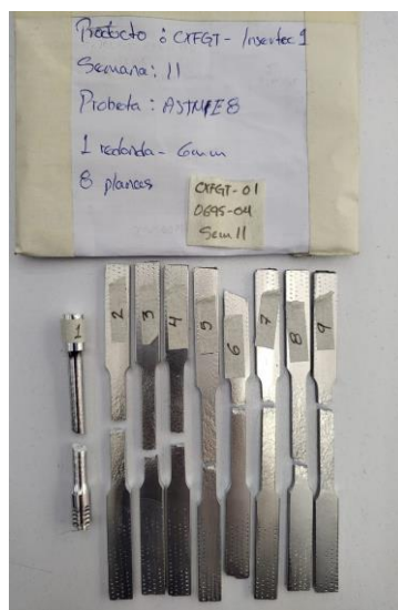
Imagen 4. Ruptura de ítems. Image 4. Broken items.
