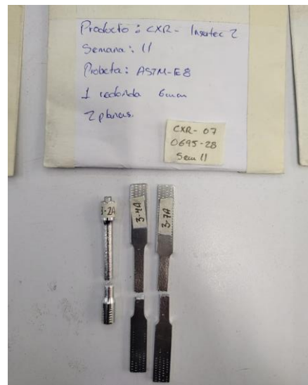
Imagen 4. Ruptura de ítems. Image 4. Broken items.
