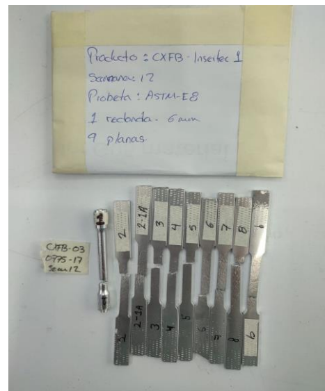
Imagen 4. Ruptura de ítems. Image 4. Broken items.
