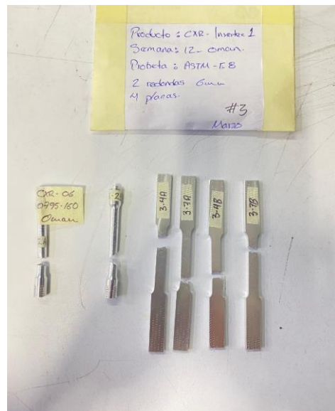
Imagen 4. Ruptura de items. Image 4. Broken items.
