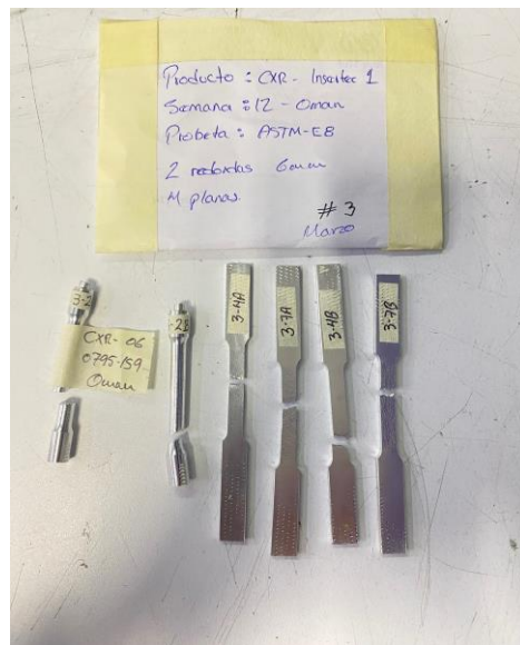
Imagen 4. Ruptura de items. Image 4. Broken items.
