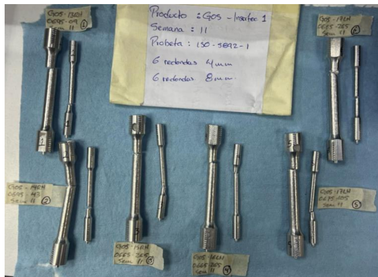
Imagen 4. Ruptura de ítems. Image 4. Broken items.
