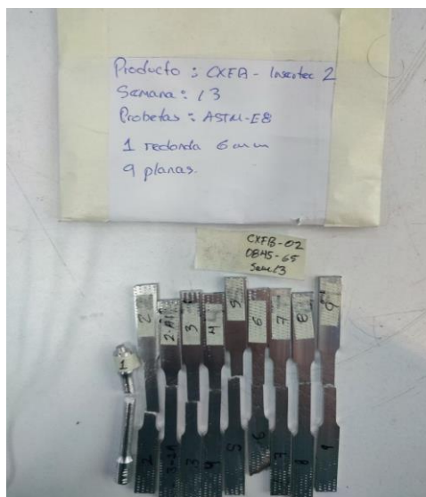
Imagen 4. Ruptura de ítems. Image 4. Broken items.
