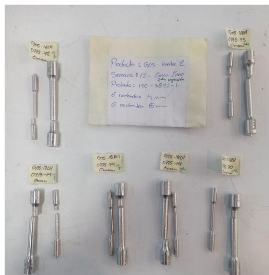
Imagen 4. Ruptura de items. Image 4. Broken items.
