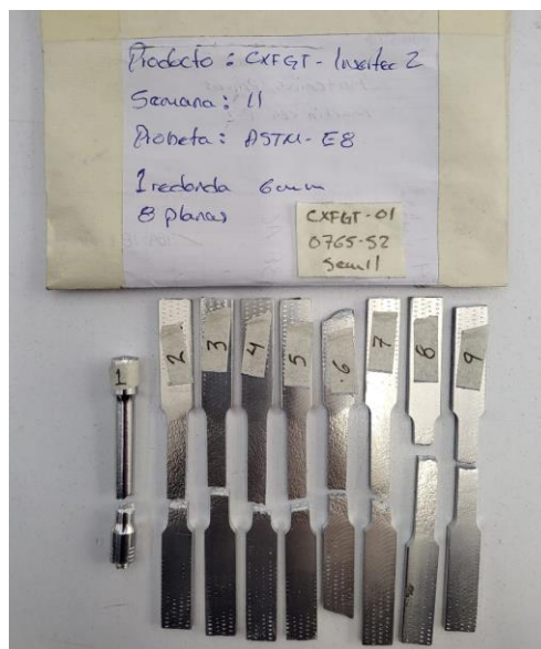
Imagen 4. Ruptura de items. Image 4. Broken items.
