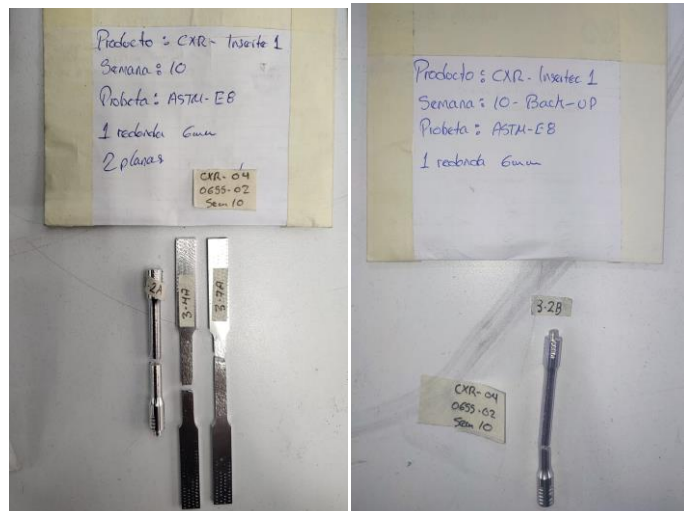
Imagen 4. Ruptura de items. Image 4. Broken items.
