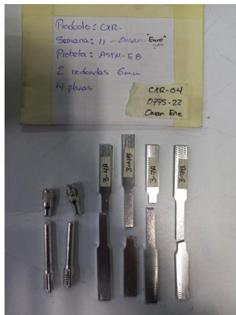
Imagen 4. Ruptura de items. Image 4. Broken items.
