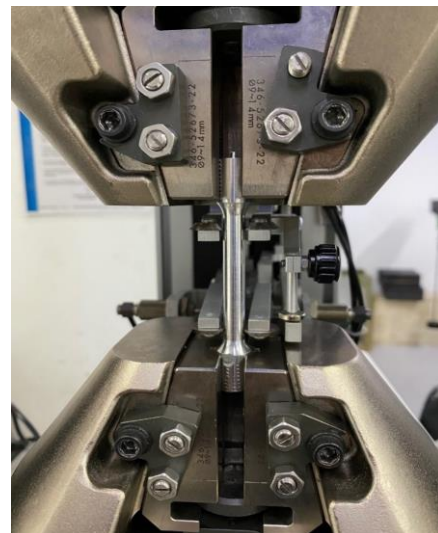
Imagen 2. Inicio de ensayos. Image 2. Test.
