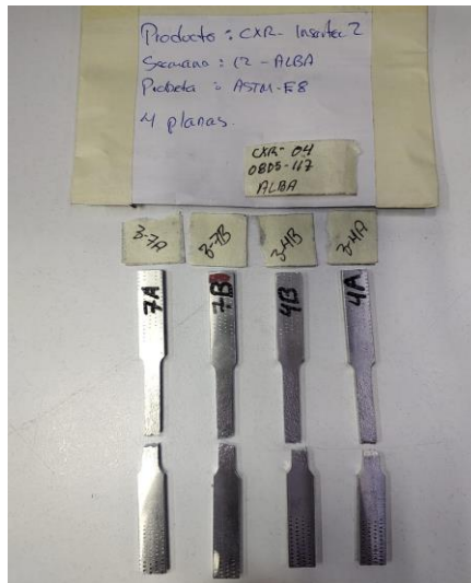
Imagen 4. Ruptura de items. Image 4. Broken items.
