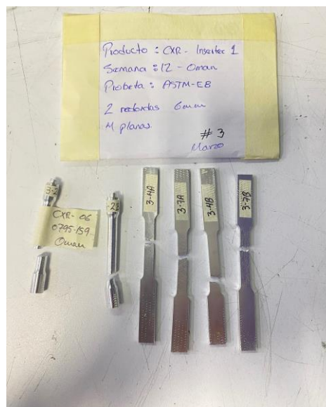
Imagen 4. Ruptura de items. Image 4. Broken items.
