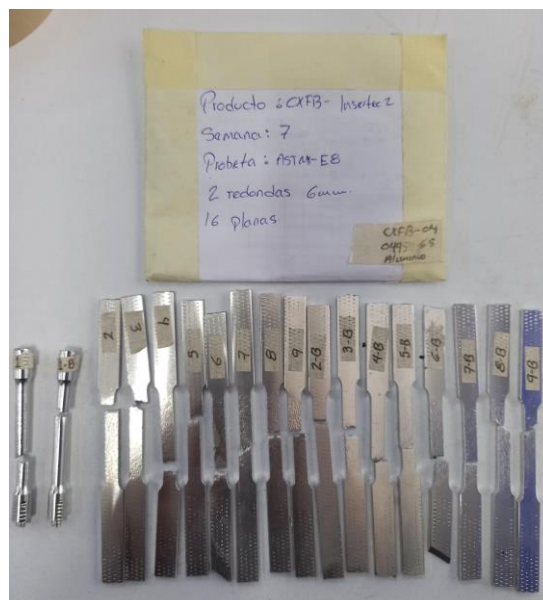
Imagen 4. Ruptura de items. Image 4. Broken items.
