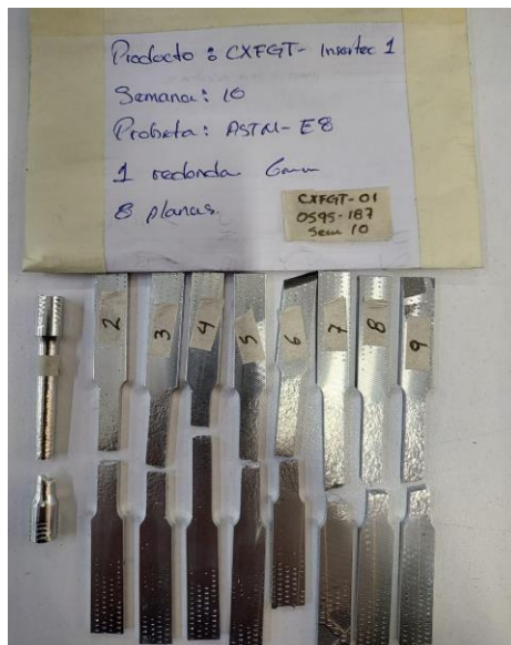
Imagen 4. Ruptura de items. Image 4. Broken items.
