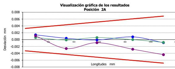
Error de palpado P<sub>Form.Sph.1x25.SS.Tact</sub>
