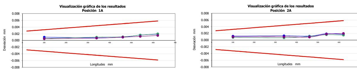
**Error de palpado P<sub>Form.Sph.1x25.SS.Tact</sub>**
