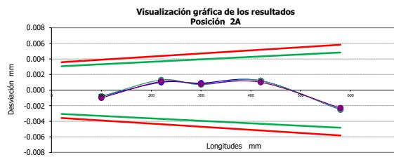
**Error de palpado P<sub>Form.Sph.1x25.SS.Tact</sub>**
